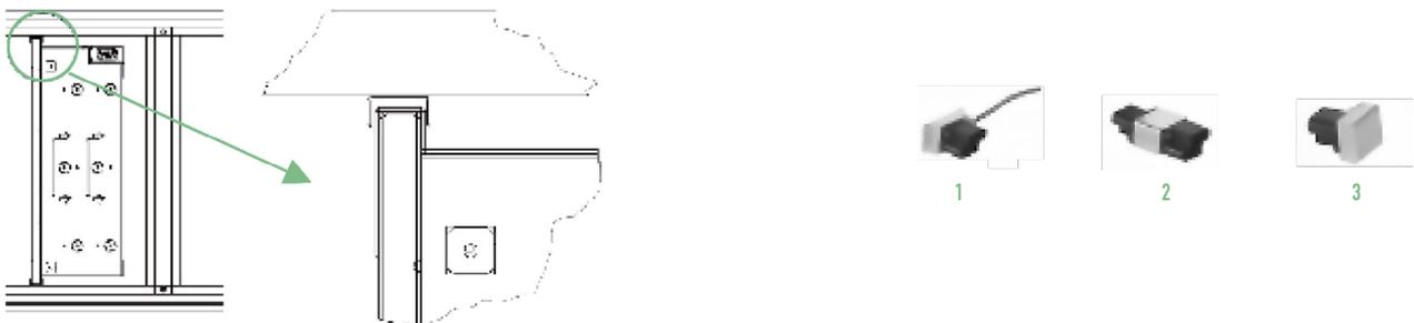
1. Inserire il connettore di alimentazione in una cella elettrostatica, togliere la pellicola protettiva del biadesivo nella parte posteriore del connettore di alimentazione, pulire il fondo ed inserire il filtro nelle guide del telaio di supporto
