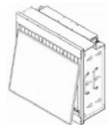
Prevedere un telaio in acciaio Inox che tenga sollevati i filtri dalla base della vasca per avere un fondo di decantazione dei fanghi. Preparare la vasca con acqua tiepida (massimo 45°C) o fredda in funzione del tipo di detergente che si sta utilizzando. Aggiungere il detergente diluito secondo le proporzioni riportate sull'etichetta della tanica e procedere:
